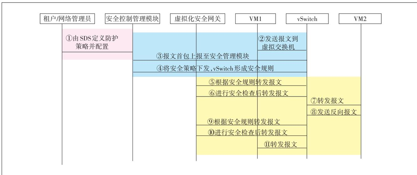
图4 基于SDS的东西向流量防护流程
