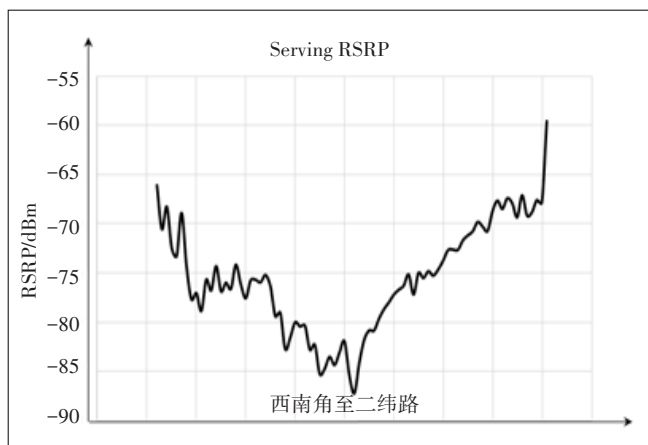
图2 某市地铁隧道内切换小区场强
