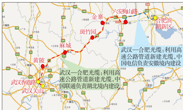
图3 中国联通、中国电信分段建设武汉—合肥光缆路由图
