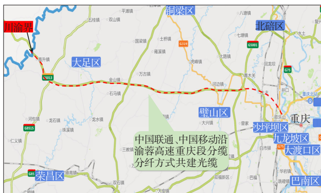
图4 中国联通、中国移动分缆分纤共建重庆段光缆路由图
