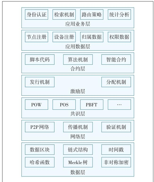
图5 访问控制区块链基础架构
