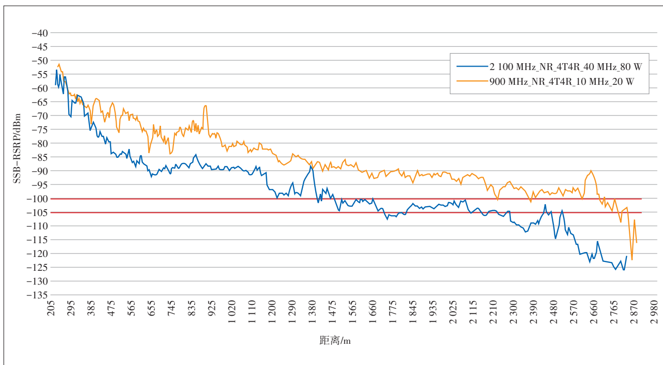
图 1 单站拉远 SSB-RSRP 测试结果
