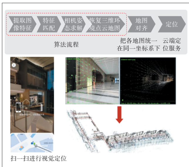
图7 AR导航算法和流程
