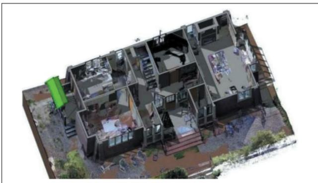
图2 三维激光扫描点云模型数据
