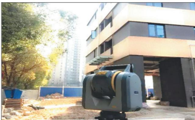
图1 三维激光扫描设备
