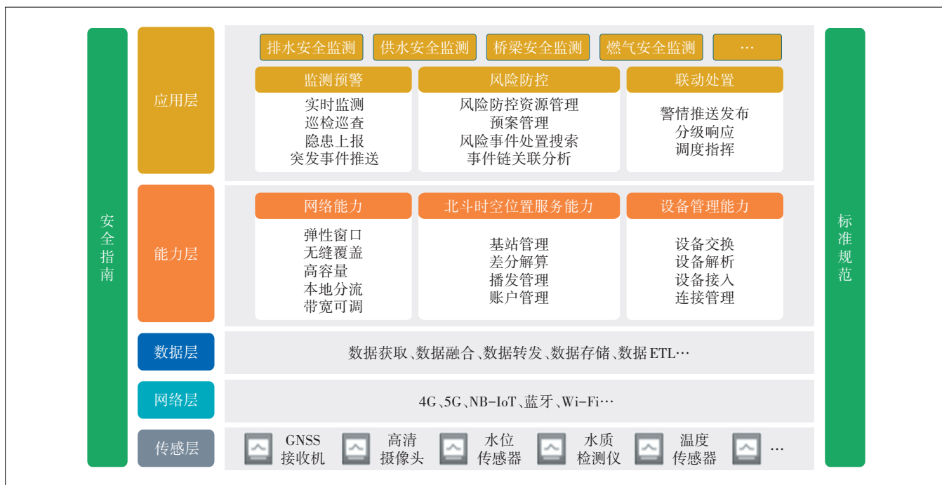
图1 基于5G+北斗技术的城市基础设施安全监测系统框架
