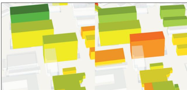
图9 某楼宇3D覆盖图(左侧站点正常、右侧站点故障)
