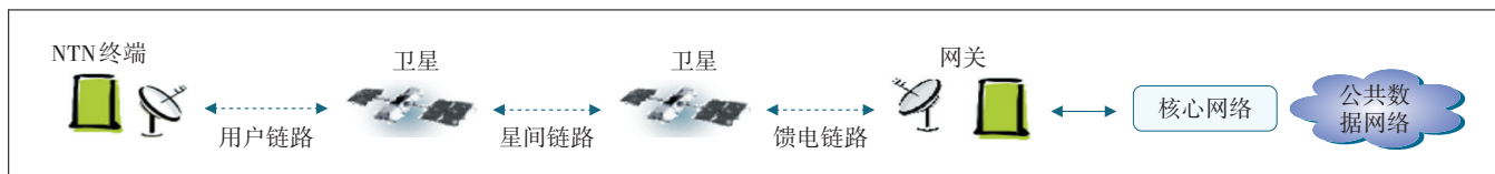
图1 卫星接入网典型系统组织架构图
