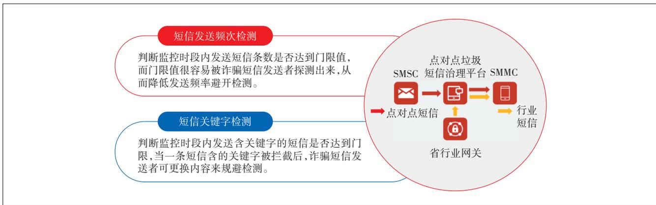
图1 垃圾短信检测手段
