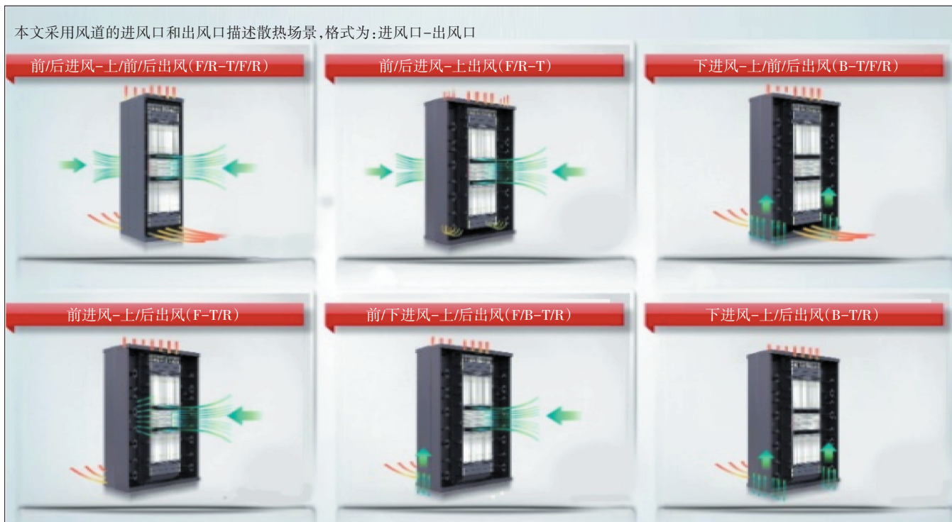
图3 传输设备散热方式场景
