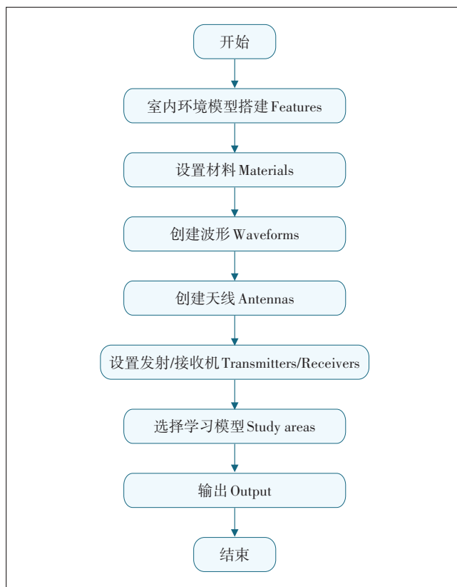
图 10 Wireless InSite 总体建模流程图
