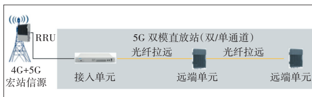
图5 宽频光纤直放站示意
