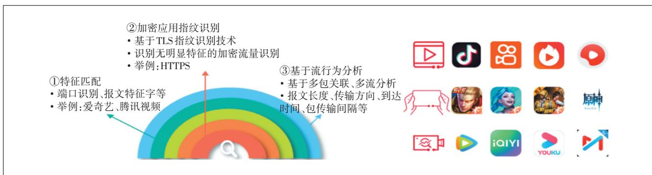
图5 基于意图驱动的业务识别方式
