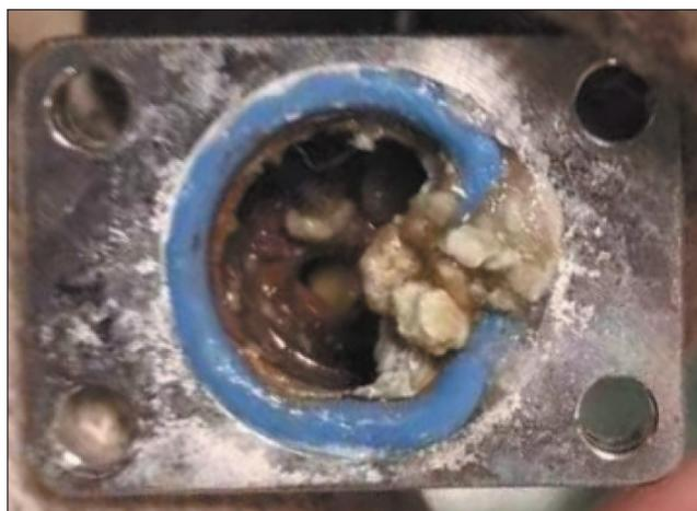
图2 法兰密封处的腐蚀附着物
