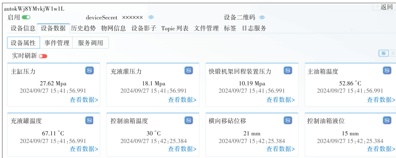
图4 基于物模型智能生成的设备数据实时上报效果
