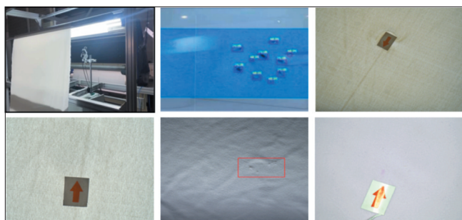
图4 基于CNN框架的胚布外观瑕疵质检现场和可视化效果
