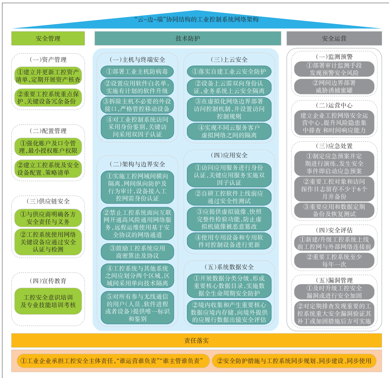
图4 “云-边-端”协同结构的工业控制系统安全防御体系架构
