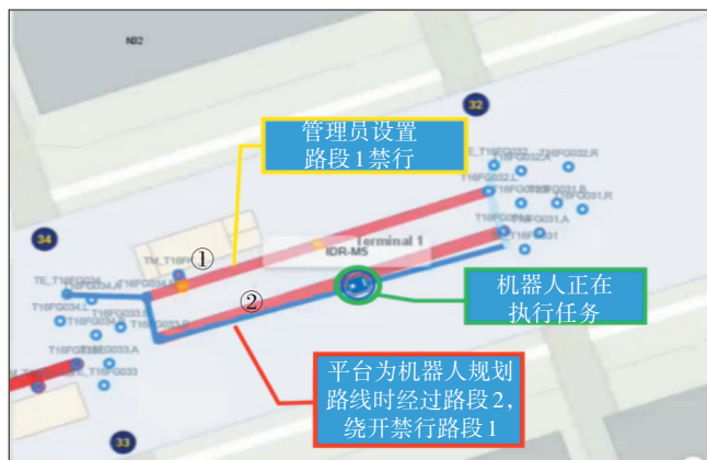
图5 路段禁行机器人绕行场景
