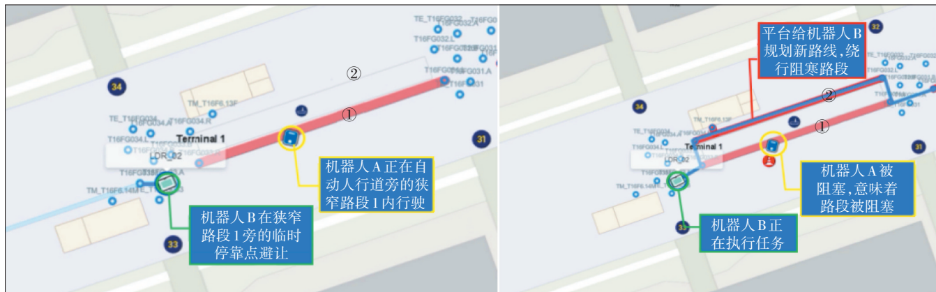
图4 路段阻塞多机器人绕行场景
