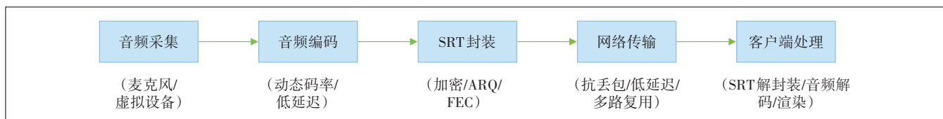
图4 云手机服务端音频流推送流程
