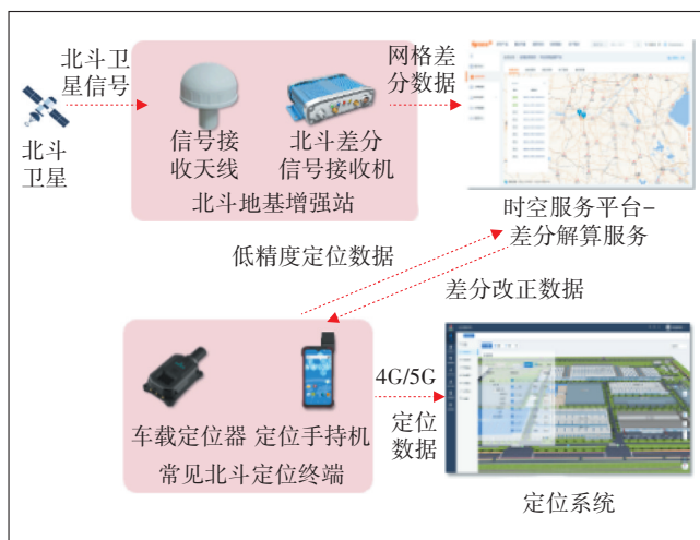
图2 北斗高精度定位原理
