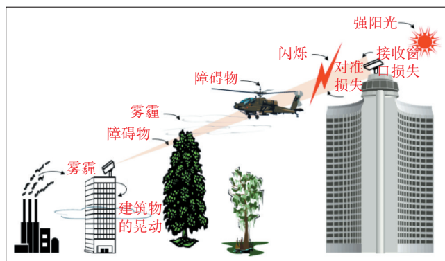
图2 大气条件对FSO在基站回传中的影响
